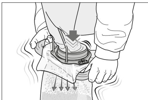
Fig. 20 Vacíe el saco colector de polvo agitándolo vigorosamente.
