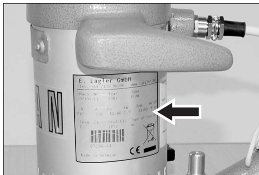
Fig. 1 Placa de identificación en la carcasa del motor.
