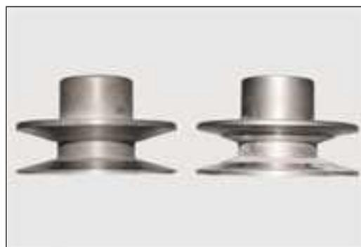
Fig. 34 A mano izquierda se ve una polea de correas nueva, a mano derecha una polea desgastada que debe ser cambiada.
